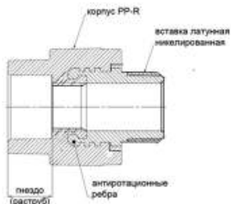
Рис.1 - Конструкции комбинированного фитинга
